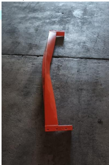
BQ 2 VIGA GOLPEADA
