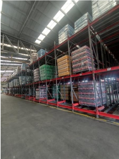
Bloque sin protectores de piso
